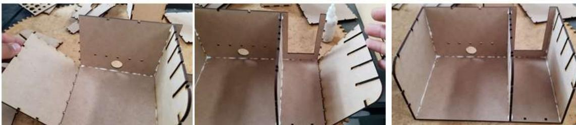
4-Voltear de espaldas el mueble y pegar la pieza 6. Las siguientes piezas tienen algo de chiste ya que deben ensamblar muy exactos. Reforzar las aristas como se muestra en la segunda foto.
