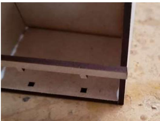
12-Pegar pieza 17 en 18 y entonces pegar la pieza donde se indica en el mueble. Es importante que lleve pegamento en el filo del frente que dará con la pieza inclinada, o reforzarlo en la arista por abajo, para que quede bien soportada.
